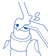
Wyczyść sondę pomiaru przewodności
